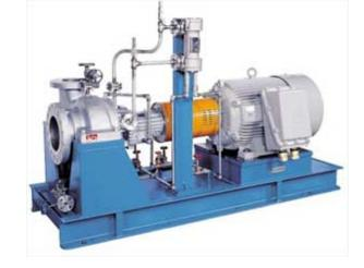
**Bomba tipo OH2:** Las bombas con denominación del tipo OH2 son con impulsor en voladizo, soportadas en la línea de centros y de una etapa. Tienen un solo alojamiento de cojinetes para absorber todas las fuerzas impuestas a la flecha de la bomba y mantiene el rotor en posición durante la operación. Las bombas son montadas sobre una base o patín común y son acopladas con cople flexible a su accionador.
