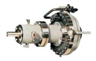
**Bomba tipo OH3:** Las bombas con denominación de tipo OH3 son con impulsor en voladizo, vertical en línea, una etapa y con cojinete en soporte. Estas bombas tienen un alojamiento de cojinete integrado a la bomba para absorber todas las cargas de la bomba. La bomba y su accionador son acopladas con acoplamiento flexible.
