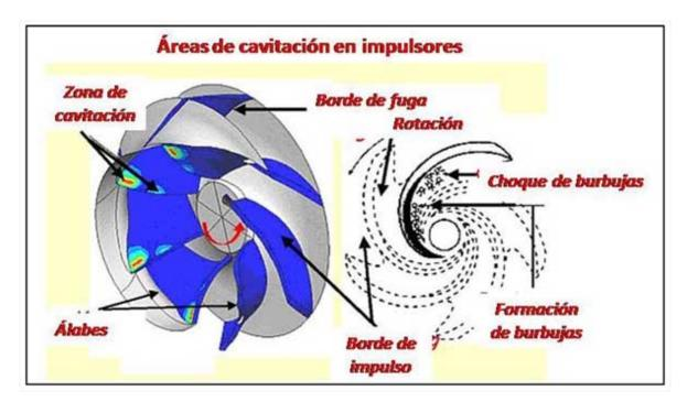
**BURBUJAS DE GAS**: Es cuando el liquido a bombear tiende a generar gases es decir se evapora al contacto con el oxigeno o en su defecto genera bolsas de aire por su densidad a esto se le conoce como **cavitación gaseosa**, este tipo de cavitación rara vez produce daños severos en el impulsor y la carcaza, su efecto principal es una perdida de capacidad, en el caso de líquidos espumosos estos normalmente no provocan cavitación.
