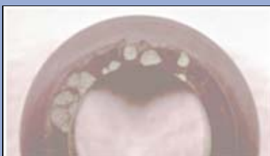
Figura no.2 Cara estacionaria de carbón con ampollas generadas por ataque térmico.
