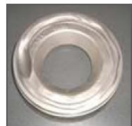
Plato adaptador dañado por la abrasión de SLURRY en minería.
